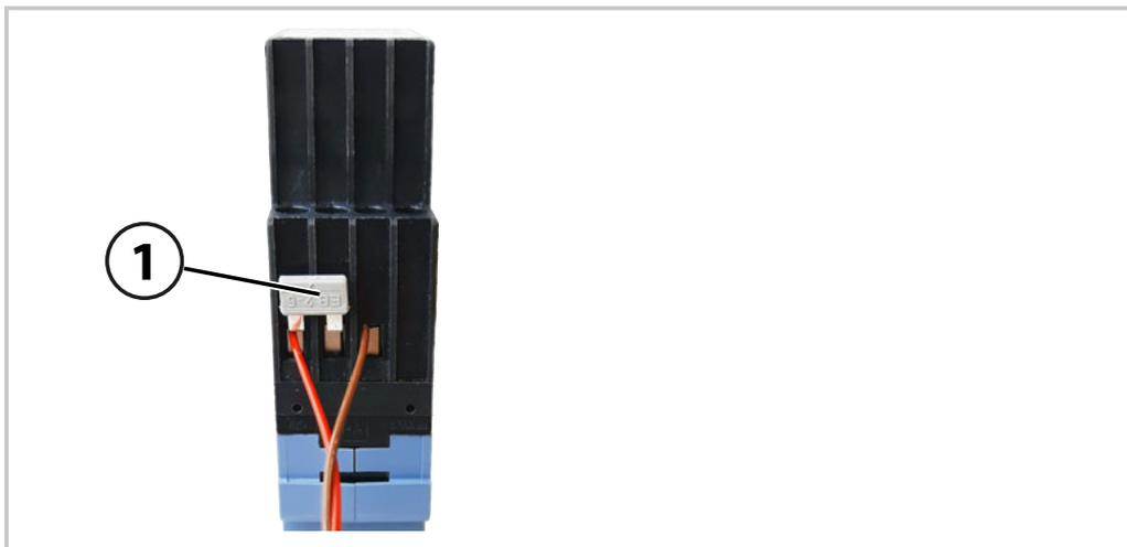
10. 连接用于输入端的电缆。根据所需要的输入范围安装跳线 **(1)** (参见图示: 端子 5 和 6 中的跳线)。
