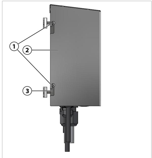
01. 松开螺栓 (1)，将 EPC720 Cover (2) 固定在底板 (3) 上（见插图）。
