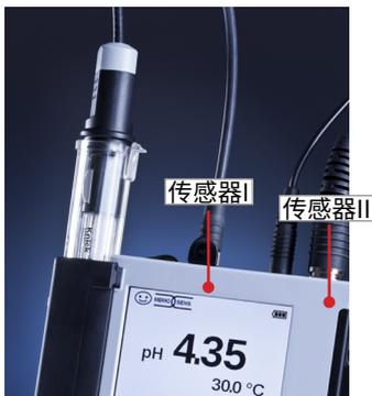
将 Memosens 传感器连接到电极焊座 I 和 II,或者将一个 Memosens 传感器连接到电极焊座 I,并将模拟传感器连接到电极焊座 II。
