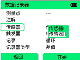
**示例:** 已选择了传感器 II。以传感器 II 为基础进行数据记录器的其他设置。视传感器类型而定, 有各种各样的参数可供使用。
