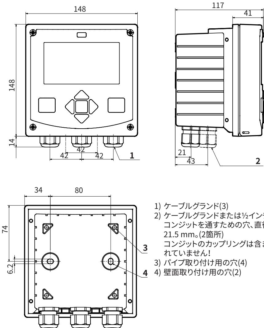
図:取り付け方法 (寸法単位はmm)
