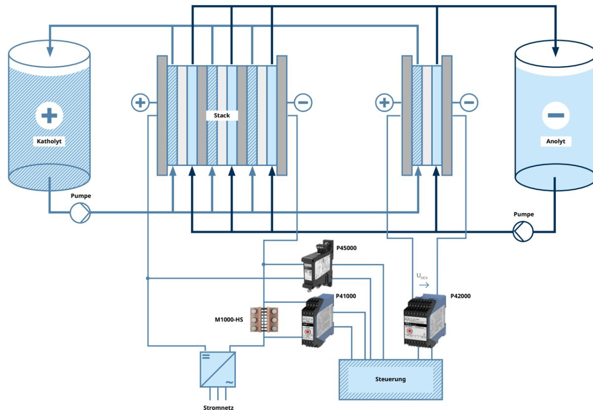
An der Zellmembran entstehen infolge von Reduktions- und Oxidationsprozessen der Elektrolyte Potenzialdifferenzen von wenigen Volt. Anlagenbetreiber verschalten hunderte dieser Zellen zu sogenannten Stacks – und diese wiederum zu Strings. Basierend auf diesem Aufbau erreichen Großbatteriesysteme Gesamtspannungen bis 1.500 V DC.
