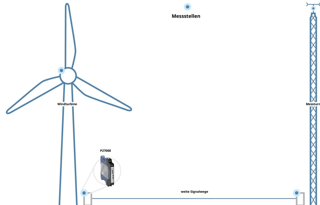
Für Messungen kommen deshalb Trennverstärker mit geringer Ausfallrate zum Einsatz, die eine galvanische Trennung zwischen Signalquelle und Auswerteeinheit gewährleisten. Gleichzeitig werden uni- sowie bipolare Signale unterschiedlicher Systeme – z.B. Datenlogger oder SCADA – zur Weiterverarbeitung in einheitliche Normsignale gewandelt.
