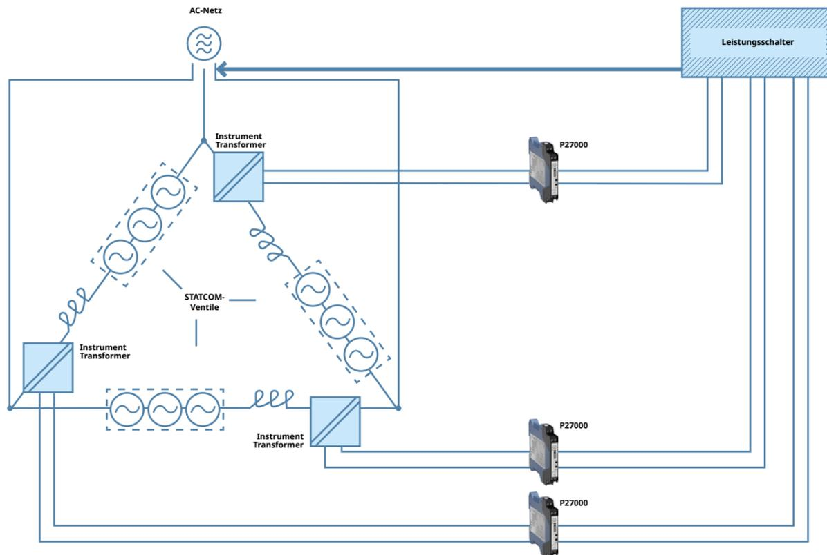
Kommt es zu einem Kurzschluss im Versorgungsnetz, wird die Stromzufuhr zu den STATCOM-Ventilen umgehend unterbrochen. Ohne diesen Schutzmechanismus könnte die Leistungselektronik der Anlage Schaden nehmen und infolgedessen die Spannungsregelung im Netz negativ beeinflussen. Eine Stromüberwachung mit Hilfe von reaktionsschnellen Trennverstärkern an jeder der drei Phasen des Systems stellt eine hohe Verfügbarkeit der STATCOM-Anlagen sicher.
