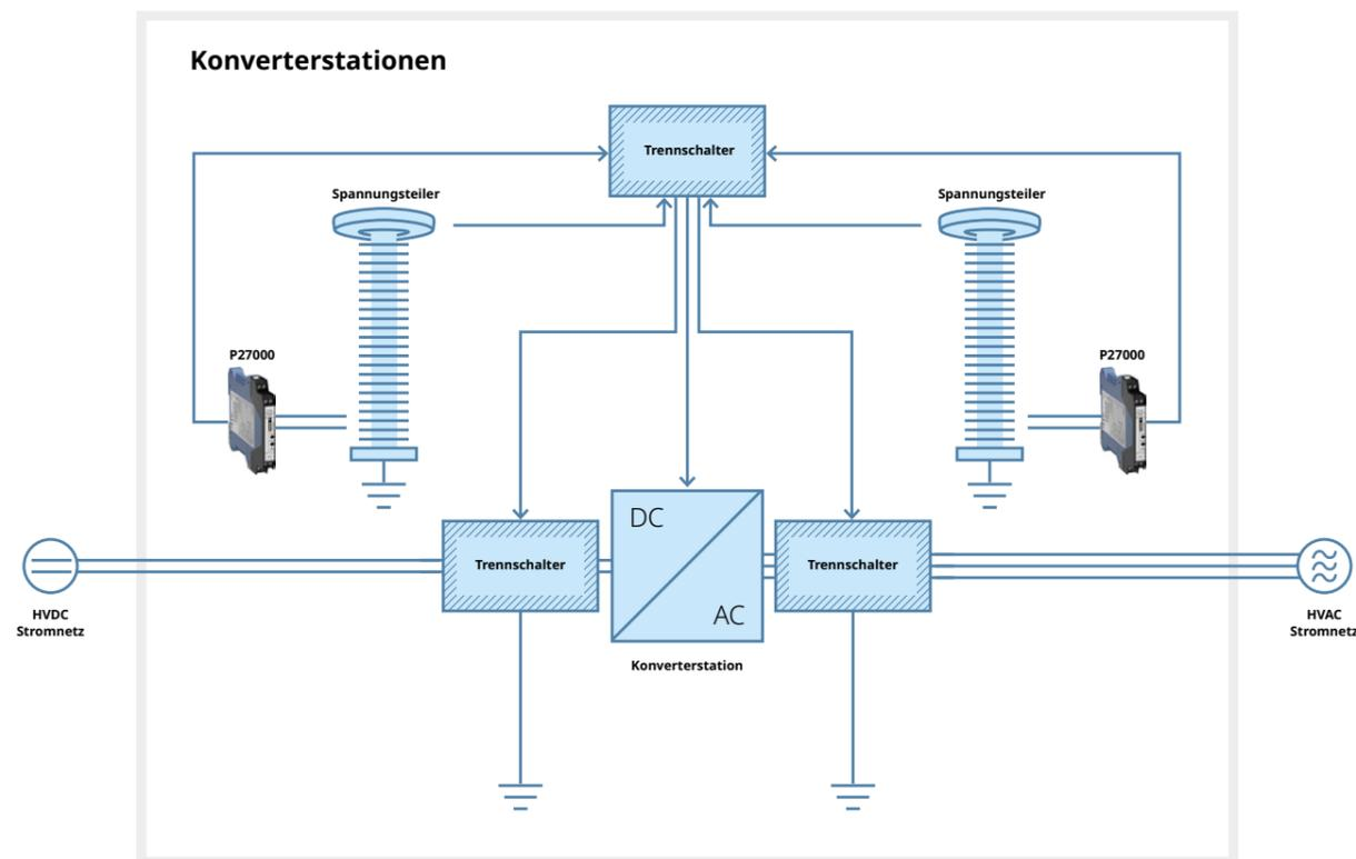
In Konverterstationen erfolgt eine Rückwandlung des zum Transport genutzten Gleichstroms in Wechselstrom. Um die Netzintegration der elektrischen Energie präzise steuern und die Sicherheit der Anlage gewährleisten zu können, ist eine kontinuierliche Spannungsüberwachung unerlässlich. Die hohen Spannungen der HVDC-Systeme lassen sich jedoch nicht direkt messen. Es benötigt resistiv-kapazitive Spannungsteiler, die die Eingangsspannung auf maximal 200 V reduzieren.
