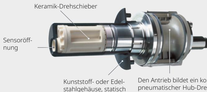
Den Antrieb bildet ein kompakter, pneumatischer Hub-Dreh-Motor mit zwangsgesteuerten, integrierten Ventilen. Dieser kann ohne Prozessunterbrechung ausgebaut werden.
