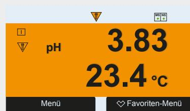
Die farbgeleitete Nutzerführung ermöglicht die Ermittlung des Sensorzustands innerhalb kürzester Zeit. Das Anzeigefeld verfügt basierend auf den NE 107 Statusmeldungen über verschiedene Hintergrundfarben. Sensorzustände und Gerätemodi können vom Anwender so auf einen Blick erkannt werden. Das Sensorüberwachungssystem zeigt den Wartungsbedarf des Sensors mithilfe von Sensoface an und kann hierfür auch mit Meldungen konfiguriert werden.
