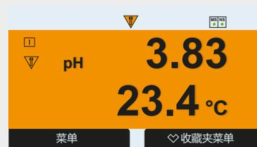
彩色指引的用户界面可以在最短时间内传达传感器状态。根据 NE 107 状态消息，显示区呈现不同的背景颜色。因此，用户可以对传感器状态和设备模式一览无遗。
