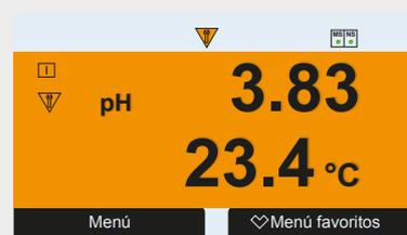
La interfaz del usuario codificada por colores permite determinar rápidamente el estado del sensor. Los campos de la pantalla presentan colores de fondo diferentes en base a los mensajes de estado según NE 107, de forma que los usuarios pueden detectar los distintos estados del sensor y los modos del dispositivo de un vistazo.
