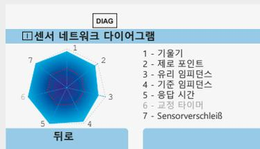
사용자는 센서 상태 및 연결된 센서의 잔여 시간에 대한 모든 정보를 한 눈에 볼 수 있습니다. 또한 센서 네트워크 다이어그램을 사용하여 센서 감시를 더 쉽게 할 수 있습니다. 제로 포인트, 기울기, 사용 수명, 교정 타이머, 임피던스 및 응답 시간과 같은 모든 관련 센서 데이터가 일목요연하게 표시됩니다.
