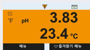
색상으로 식별되는 사용자 인터페이스를 통해 센서 상태를 빠르게 확인할 수 있습니다. 디스플레이 필드의 배경색은 NE 107 상태 알림에 따라 바뀝니다. 따라서 사용자가 센서 상태와 기기 모드를 한 눈에 식별할 수 있습니다. 센서 감시 시스템은 Sensoface 기능을 사용하여 센서의 유지·보수 필요성을 보여주고 알림을 통해서도 이를 구성할 수 있습니다.
