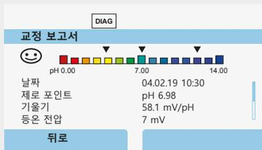
적응형 교정 타이머를 사용하여 교정 간격을 효율적으로 조정합니다. 또한 부하를 그래픽으로 표시하는 새로운 기능에서는 각 센서에 노출된 극한값에 대한 정보를 제공합니다.
