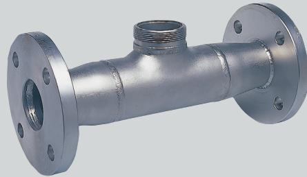
단면 DN 50의 파이프 라인에 직접 설치하기 위한 직선형 통과 방식 피팅. 메인 스트림 또는 바이패스에서의 측정에 사용 가능. 스테인리스 강 재질, 높은 온도 / 압력에서도 사용 가능. pH, ORP 전압, 온도, 일반 및 유도식 전도도와 산소에 대한 다양한 센서를 사용하기 위한 어댑터. 밀폐력으로 인해 미량의 산소 측정에도 적합합니다. 유도식 전도도 센서와 같은 대형 센서 설치 시에는 적합한 단면 확장으로 인해 압력 손실이 별로 없습니다. 액상 전해질로 채워져 있으며 보충이 가능한 pH 센서용 내장된 전해질 탱크의 보호 후드.
