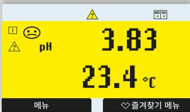
황색: NE 107 상태 알림 "사양을 벗어난 상태"
