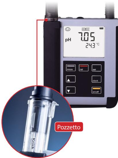
**Portavo 902 PH** è un apparecchio di misurazione portatile del pH. Il comando è molto intuitivo grazie ad una riga di testo chiaro in un display LCD pieno di contrasto.
