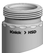
**ZU0923 Attacco saldato di sicurezza (obliquo 15°) HSD per pareti caldaia**
