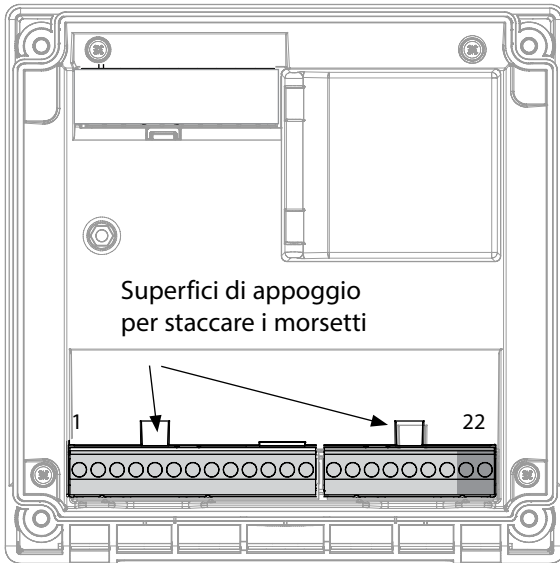
Figura: morsetti, apparecchio aperto, retro dell'unità frontale
