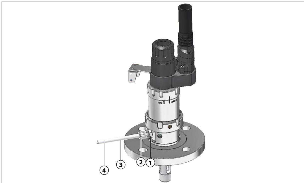
01. Avvitare saldamente il tubo flessibile di deflusso (3) tramite il collegamento a vite per tubo flessibile (2) ai raccordi di deflusso (1).
