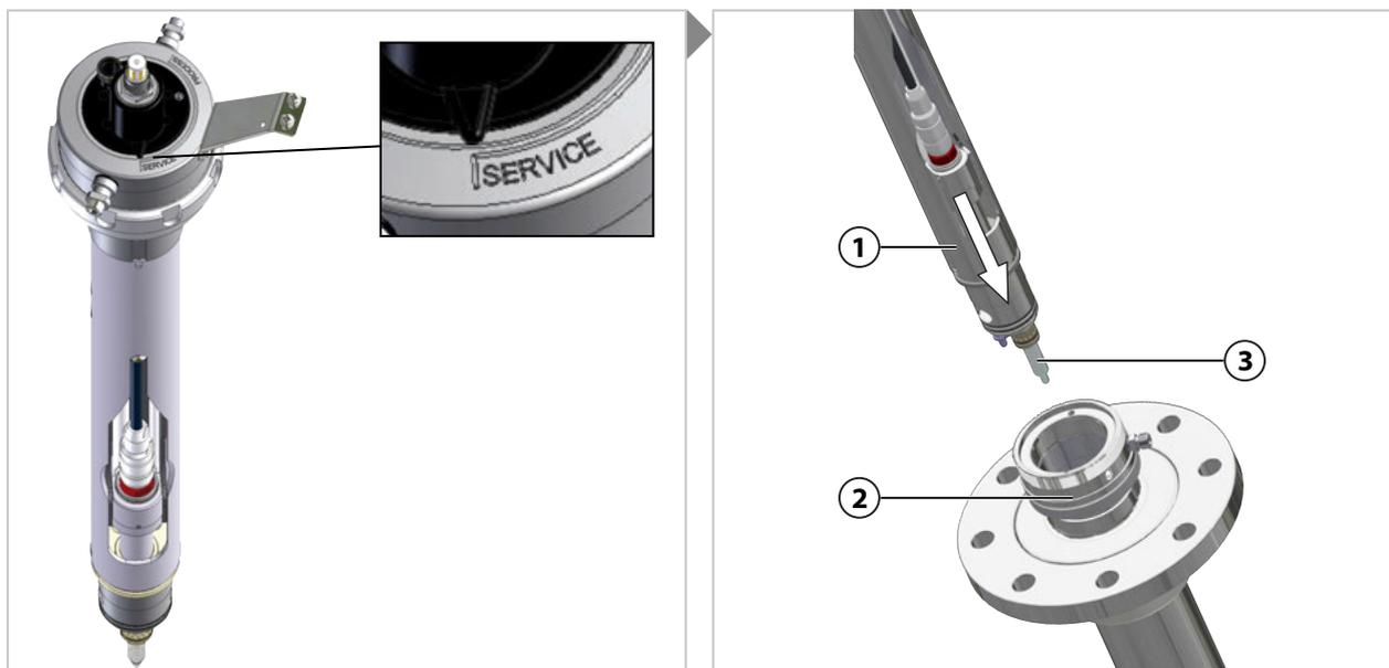
01. Assicurarsi che l'unità di azionamento (1) sia in posizione di manutenzione (finecorsa SERVICE).
