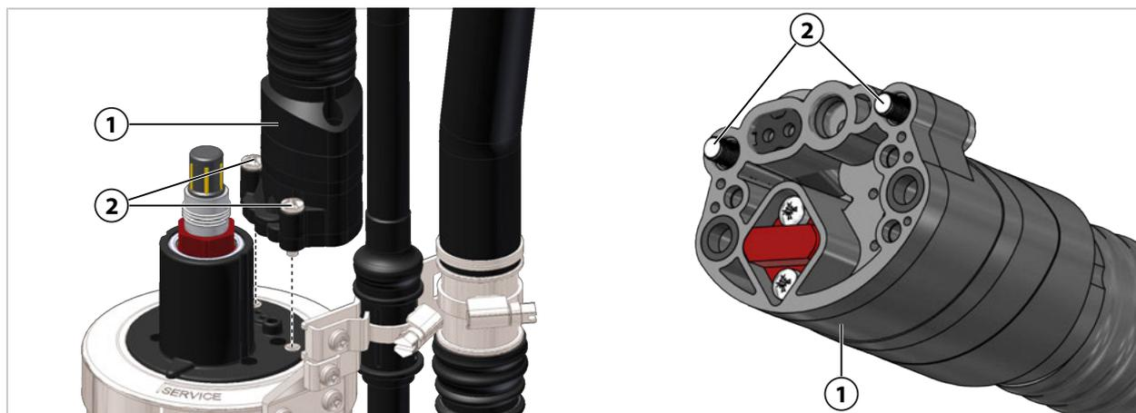
01. Controllare che le guarnizioni e gli O-ring del connettore multiplo (1) siano posizionati correttamente e che non siano danneggiati, event. sostituirli. → *Risoluzione dei guasti, p. 40*
