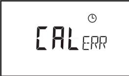
The icon shows the text 'CALERR' in a stylized font. Above the 'A' is a small circle with a downward-pointing arrow, indicating a warning or error status. | <p><b>센서의 드리프트가 너무 커서 약 2분 후 교정이 취소되었습니다.</b></p> <ul style="list-style-type: none"><li>• 센서 결함</li><li>• 센서 오염됨</li><li>• 센서에 전해질 없음</li><li>• 센서 케이블이 충분히 차폐되지 않았거나 센서 케이블 결함</li><li>• 강한 전기장이 측정에 영향을 미침</li><li>• 완충액의 온도 변화가 심함</li><li>• 완충액이 전혀 희석되지 않았거나 너무 많이 희석됨</li></ul> |
