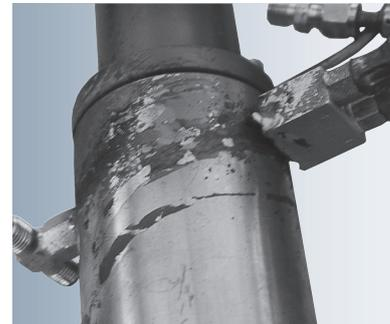
Armature retrattili convenzionali: groviglio di tubi (sinistra) e depositi su meccanismo di finecorsa non protetto (destra)
