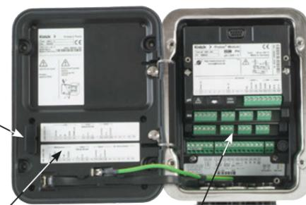
**Autocollant plaque à bornes (modules « cachés »)**
