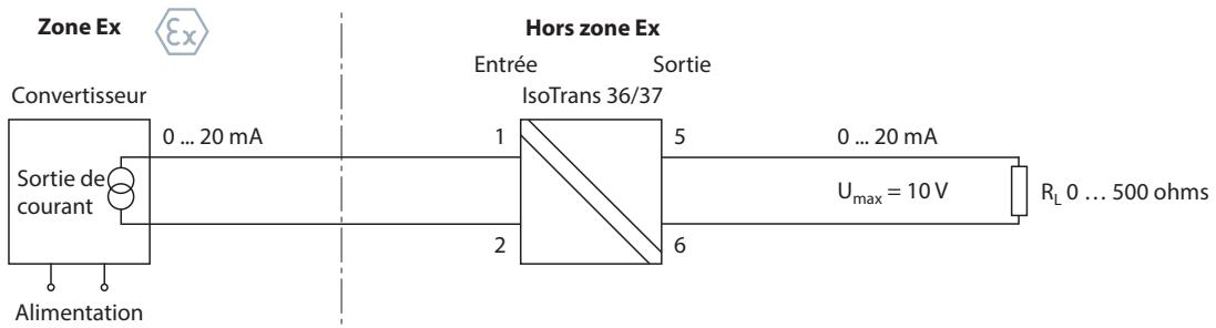
pour le raccordement avec des circuits électriques à sécurité intrinsèque avec les valeurs maximales suivantes :
