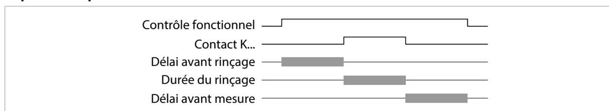
**Remarque :** Le contrôle fonctionnel (HOLD) est activé du début du délai de mise en route jusqu'à la fin du temps d'inertie. Les sorties de courant et les autres contacts de commutation réagissent conformément à leur programmation.
