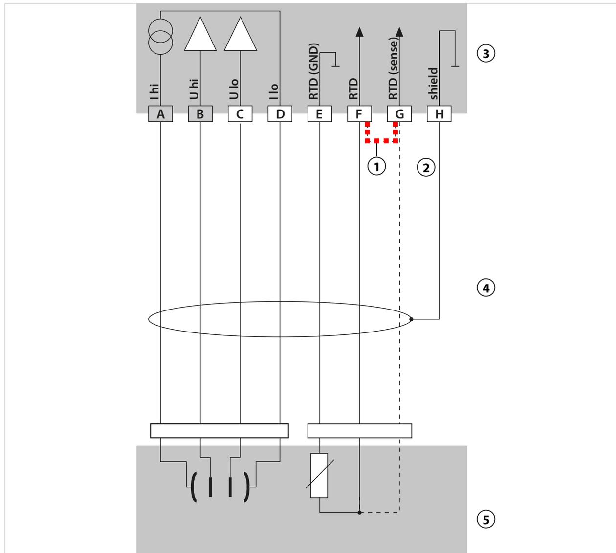
1 Installer un pont d'insertion entre F et G en cas d'utilisation d'une sonde de température à 2 fils !
