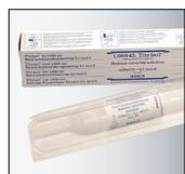
Pour déterminer et contrôler les constantes de cellule, 1 ampoule pour la réalisation de 1000 ml de solution NaCl 0,1 mol/l (12,88 mS/cm)
