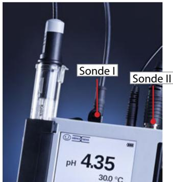
Les sondes Memosens sont raccordées aux prises de sonde I et II ou une sonde Memosens est raccordée à la prise de sonde I et une sonde analogique à la prise de sonde II.
