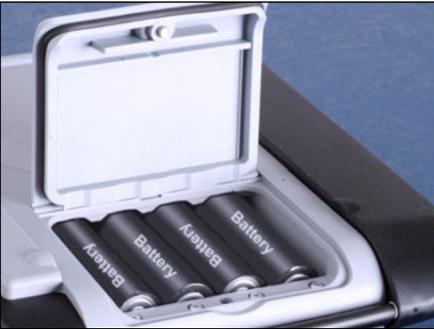
Avec ses quatre piles AA, le Portavo atteint une durée de fonctionnement de jusqu'à 500 h en mode logger (voir page 38).
