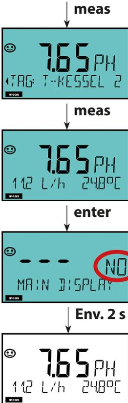
Une courte pression sur **meas** permet d'activer d'autres affichages, le nom du poste de mesure (TAG) ou le débit (L/h) par exemple. Ces derniers apparaissent sur fond turquoise et passent en affichage principal au bout de 60 s.
