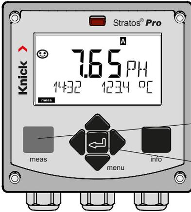
L'affichage actif en mode Mesure est appelé MAIN DISPLAY. Pour activer le mode Mesure à partir des autres modes, appuyer longuement sur la touche **meas** (> 2 s).
