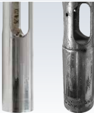
Un tuyau d'immersion traditionnel après une utilisation de longue durée : formation de stries et de dépôts
