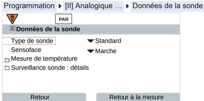
01. Dans **Mesure de température**, sélectionner la sonde de température utilisée et déterminer si la température doit être mesurée automatiquement ou manuellement pendant la mesure et/ou le calibrage.
