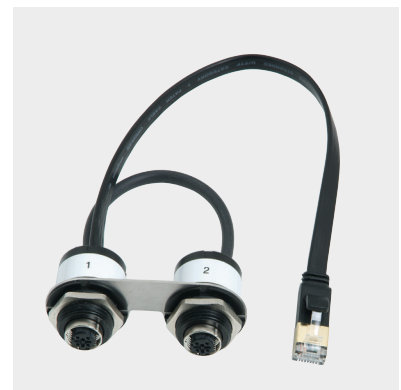
Das Y-Kabel ZU1139 verbindet die RJ45-Buchse des Stratos Multi E461N mit zwei M12 D-Typ-Buchsen und dient der Datenübertragung via PROFINET.
