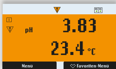
ORANGE: NE 107 Statusmeldung „Funktionskontrolle“
