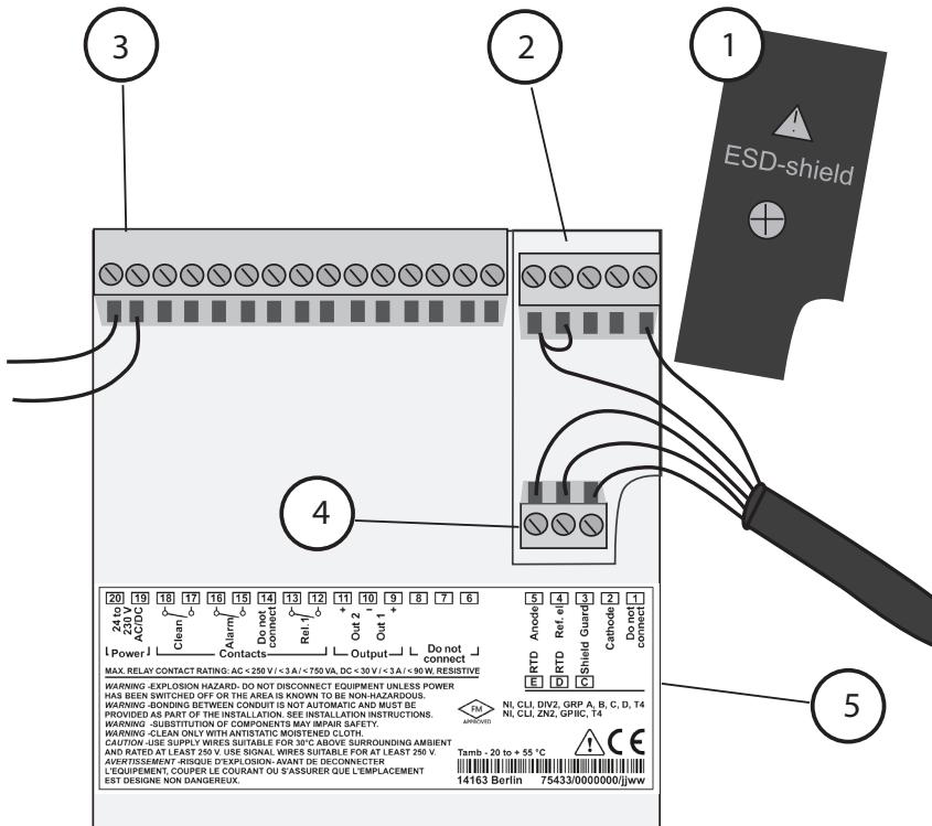
1 信号输入端的屏蔽罩（安装时拧出）
