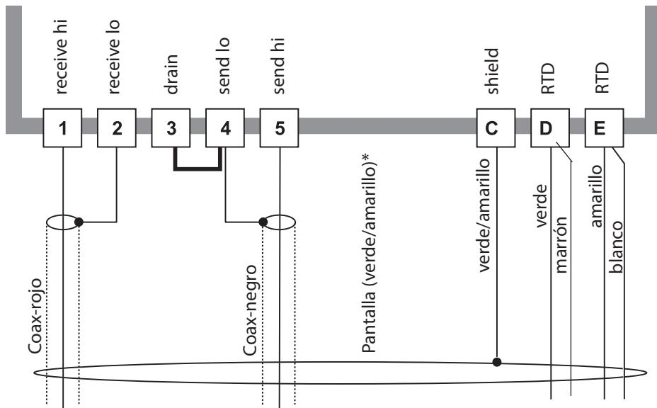
\* Los conductores de la pantalla (verde/amarillo) se deben unir mediante un anillo de apriete con el trenzado del apantallamiento del cable especial de medición (véase el manual de instrucciones completo, "Preparing the Shield Connection").
