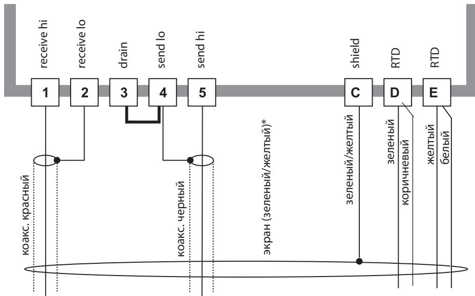
\* Экранирующая жила (зеленая/желтая) должна быть соединена с экранирующей оплеткой специального измерительного кабеля через зажимное кольцо (см. полную инструкцию по обслуживанию, "Подготовка экранированного соединения").
