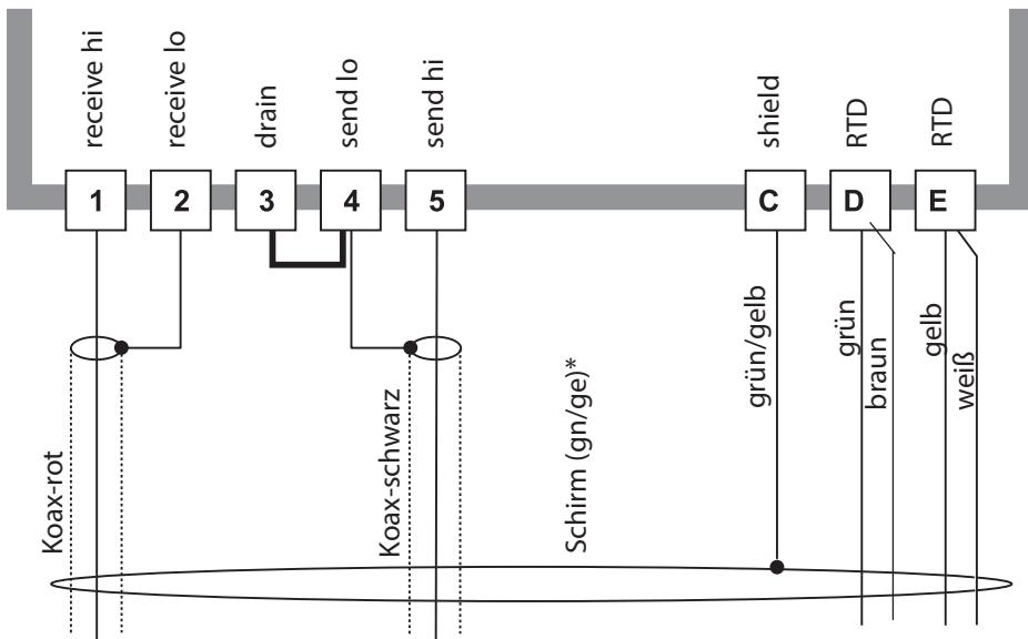
\* Die Schirmader (grün/gelb) muss über einen Quetschring mit dem Abschirmgeflecht des Spezial-Messkabels verbunden werden (siehe vollständige Bedienungsanleitung, „Vorbereitung Schirmanschluss“).
