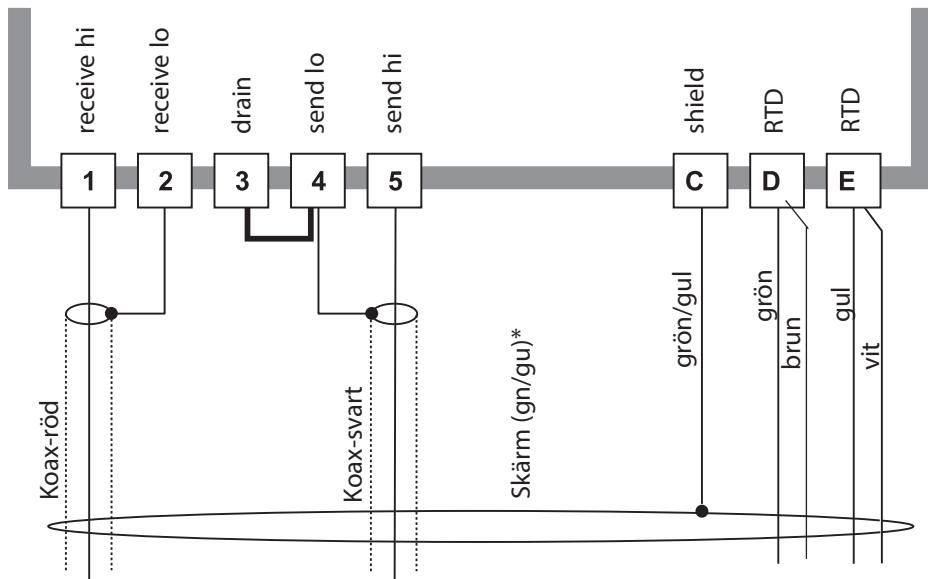
\* Den skärmade kabeln (grön/gul) måste kopplas till specialmätkabelns avskärmade tvinnade trådar via en klämring (se den fullständiga instruktionsboken, "Förberedelse skärmanslutning").
