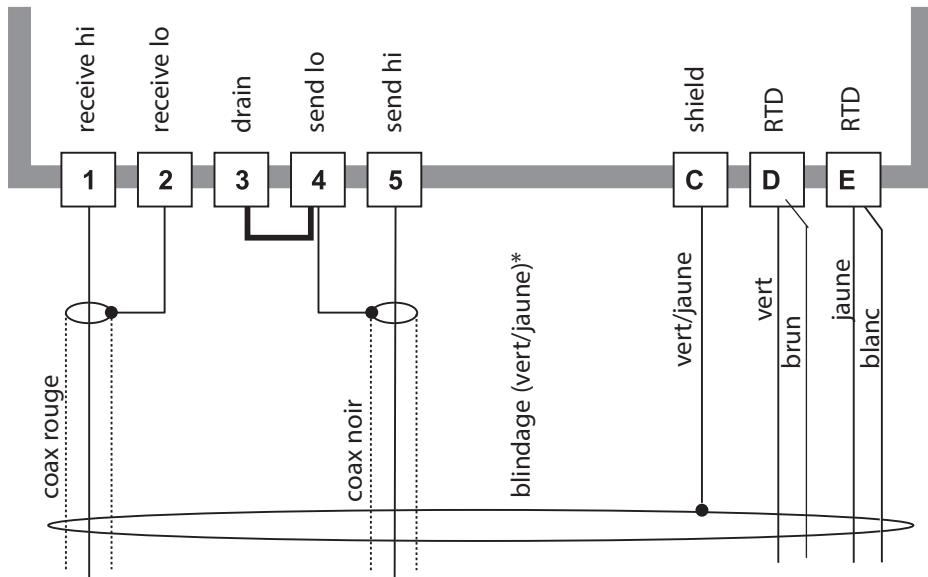
\* Le brin de blindage (vert/jaune) doit être relié par une bague de serrage à la tresse de blindage du câble de mesure spécial (voir mode d'emploi complet "Prepping the Shield Connection").
