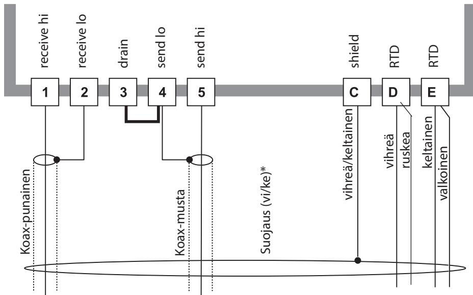
\* Suojajohdin (vihreä/keltainen) on liitettävä puristusrenkaan kautta erikoismittaushaapelin suojauspunkokseen – katso täysspitkä käyttöohje, "Preparing the Shield Connection" (Suojausliittännän valmistelu).
