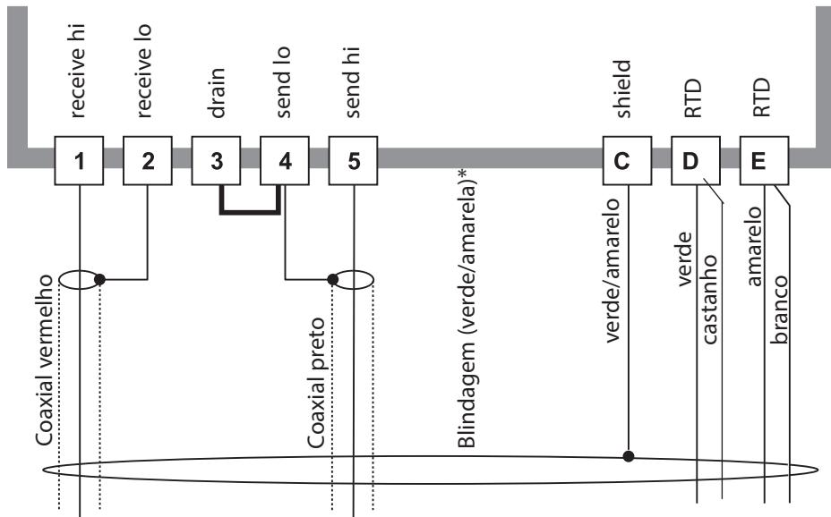
\* O fio condutor (verde/amarelo) deve ser envolvido com a rede de blindagem do cabo de medição especial com um anel de aperto (ver manual de instruções completo, "Preparing the Shield Connection").
