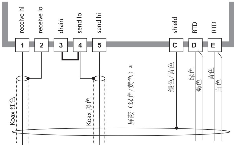
\* 屏蔽芯线（绿色/黄色）必须通过一个夹环与专用测量电缆的屏蔽层连接（参见完整的操作说明，“Preparing the Shield Connection”）。
