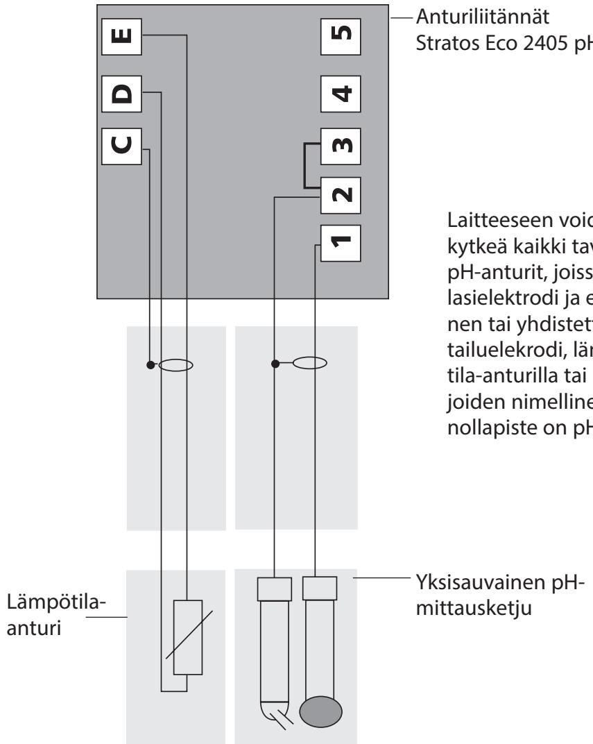
Laitteeseen voidaan kytkeä kaikki tavalliset pH-anturit, joissa on lasielektrodi ja erillinen tai yhdistetty vertailukelekrodi, lämpötila-anturilla tai ilman, joiden nimellinen nollapiste on pH 7.
