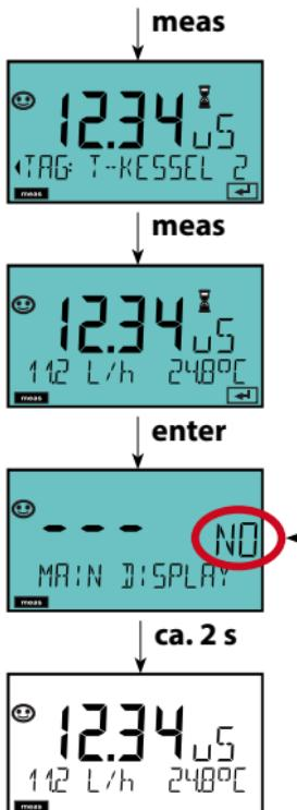
Kurzes Drücken von **meas** ruft weitere Displaydarstellungen auf, zum Beispiel Messstellenbezeichnung (TAG) oder Durchfluss (L/h). Diese sind türkis hinterleuchtet und wechseln nach 60 s zum Hauptdisplay.
