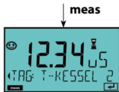
Une courte pression sur **meas** permet d'activer d'autres affichages, le nom du poste de mesure (TAG) ou le débit (L/h) par exemple.
