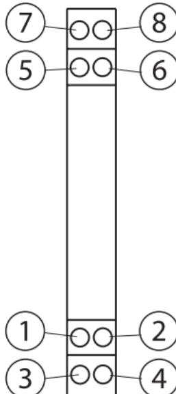
Section de raccordement max. 2,5 mm<sup>2</sup>
