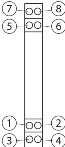
Anschlussquerschnitt max. 2,5 mm<sup>2</sup>
