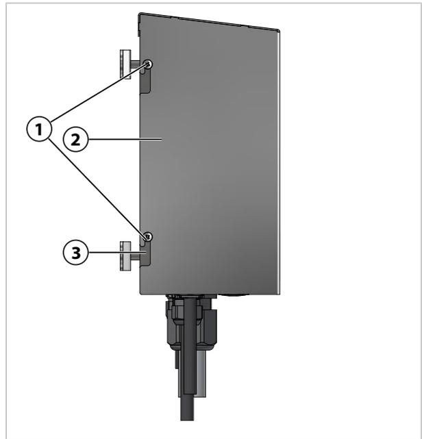
01. Aflojar los tornillos (1) y fijar el EPC720 Cover (2) a la placa base (3) (ver figura).
