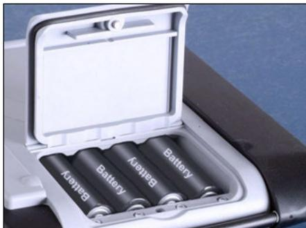
El Portavo utiliza cuatro pilas AA que le dan un rendimiento de más de 1000 h. Abra el compartimento para pilas en la parte de atrás del aparato. Preste atención a la polaridad de las pilas a la hora de colocarlas (fíjese en el dibujo que hay en el compartimento). Coloque la tapa del mismo de nuevo y atornillela para que quede bien fijada.
