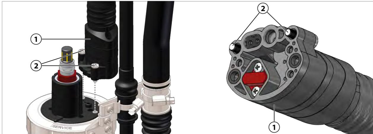
01. Comprobar que las juntas y las juntas tóricas del multiconector **(1)** se encuentren en la posición correcta y que no tengan daños. Si es necesario, reemplazarlas. → *Solución de averías, p. 38*
