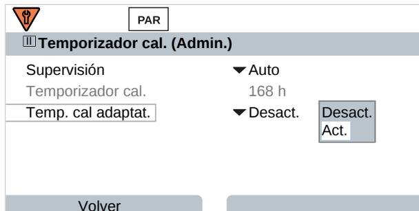
**Nota:** Si el ajuste Sensoface está habilitado, se mostrará un smiley neutro una vez que haya transcurrido el 80 % del intervalo. Una vez transcurrido el intervalo completo, se muestra un smiley triste, se genera un mensaje de mantenimiento requerido y se muestra el icono NAMUR correspondiente y la pantalla de medición se muestra con retroiluminación azul (color de la pantalla: NE107). Si las salidas de corriente están configuradas como corresponde, se genera una señal de error de 22 mA.
