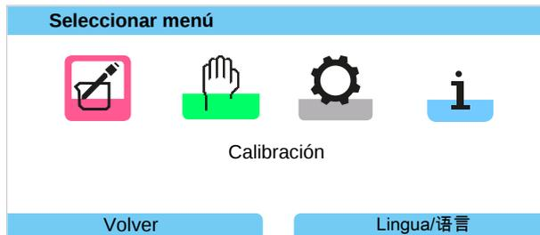
Durante la calibración, Stratos Multi permanece en el Modo calibración hasta que el personal especializado lo finaliza. Al salir del Modo calibración se muestra una consulta de seguridad para garantizar que la instalación vuelve a estar operativa.
