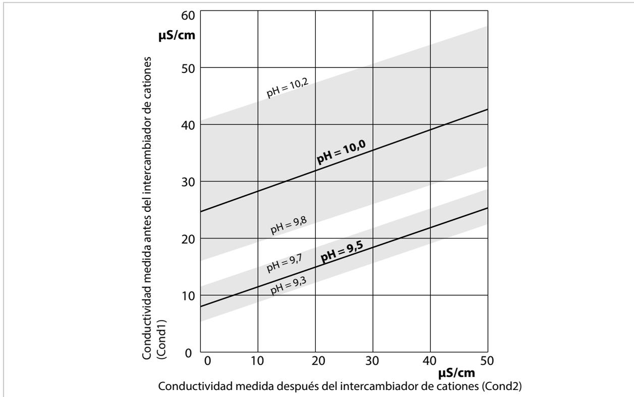
Acondicionamiento del agua de la caldera de circulación natural con hidróxido de sodio. Relación entre el valor pH y la conductividad medida antes o después del intercambiador de cationes.
