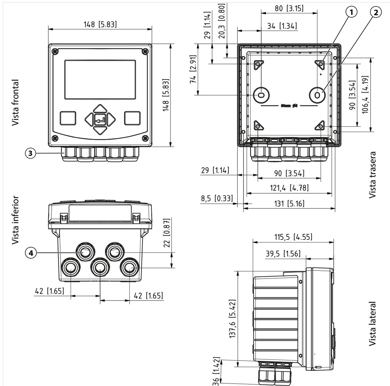
1 4 orificios para el montaje en tubería
