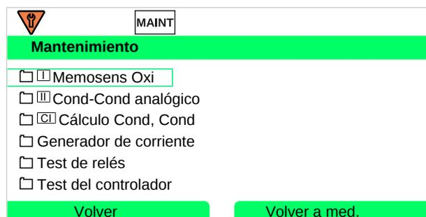
El menú mantenimiento ofrece diferentes funciones para la comprobación de la función del dispositivo:
