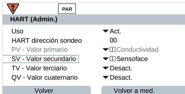
En el menú **HART** se puede ajustar la dirección de consulta (*Polling Address*) del dispositivo. En el estado de entrada se ha ajustado el valor cero (representación 0). El modo Multi Drop se activa con valores entre "01" hasta "63". En el modo Multi Drop, la corriente de salida es constante 4 mA.
