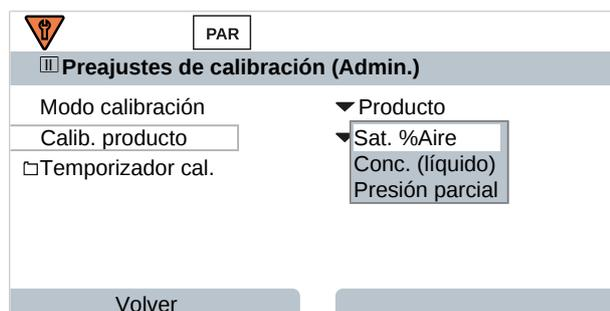
Los ajustes se efectúan en el submenú **Preajustes de calibración** :
