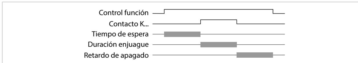
**Nota:** El control de función (HOLD) se activa desde el inicio del tiempo de preparación hasta el final del retraso de seguimiento. Las salidas de corriente y los contactos de relé restantes se comportan de acuerdo con la parametrización.
