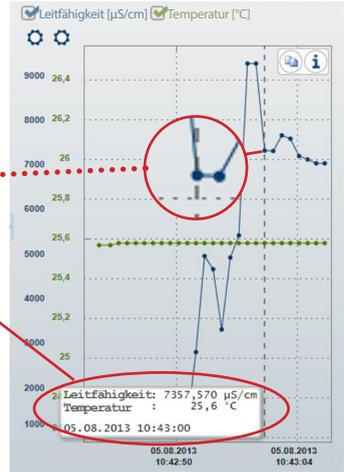
Befindet sich die gestrichelte Linie zwischen zwei Punkten, so werden die Zwischenwerte berechnet (linear interpoliert) und in grauer Schrift angezeigt.
