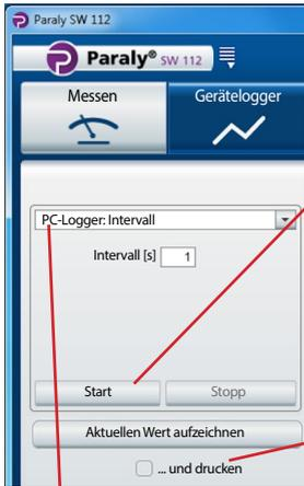
**Achtung!** Mit dem PC-Logger gestartete Messungen werden nur auf dem PC gespeichert, nicht im Gerät.
