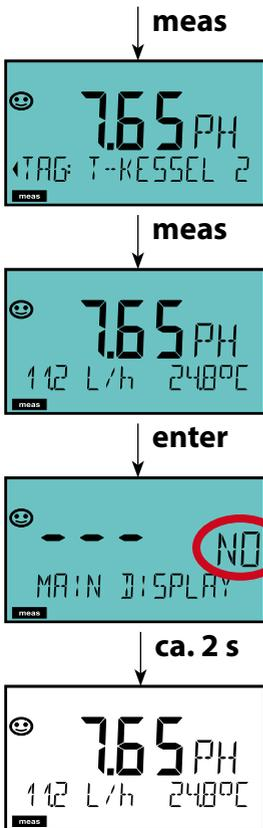
Kurzes Drücken von **meas** ruft weitere Displaydarstellungen auf, zum Beispiel Messstellenbezeichnung (TAG) oder Durchfluss (L/h).
