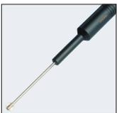
Der Eintauchrührer verkürzt die Einstellzeit des Sensors beim Messen und beim Kalibrieren. Bei Präzisionsmessungen nach DIN 19268 ist das Rühren sogar vorgeschrieben. Um das Verspritzen von Messgut zu verhindern, stoppt der Rührer beim Anheben des Stativwagens augenblicklich. Zur Versorgung des Rührers dient das Stecker-Netzgerät ZU 6956.
