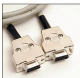
zur Verbindung Gerät – Rechner (EMV-gerechtes Spezialkabel)
