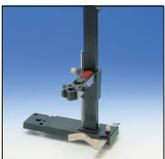
Das Anbaustativ nimmt neben dem Eintauchrührer drei beliebige Messfühler auf. Die einstellbaren Anschläge verhindern eine Beschädigung von Sensor und Becher glas. Auch das zeitraubende Justieren beim Probenwechsel entfällt. Ein integrierter Kabelkanal beseitigt den „Kabelsalat“ auf dem Labortisch. Für die Aufnahme des Eintauchrührers Typ ZU 6955 und dreier beliebiger Sensoren. Befestigung direkt am Gerät.
