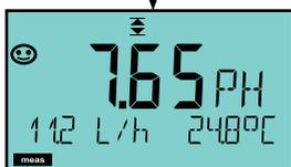
Kurzes Drücken von **meas** ruft weitere Displaydarstellungen auf, zum Beispiel Durchfluss (l/h). Diese sind türkis hinterleuchtet und wechseln nach 60 s zum Hauptdisplay.
