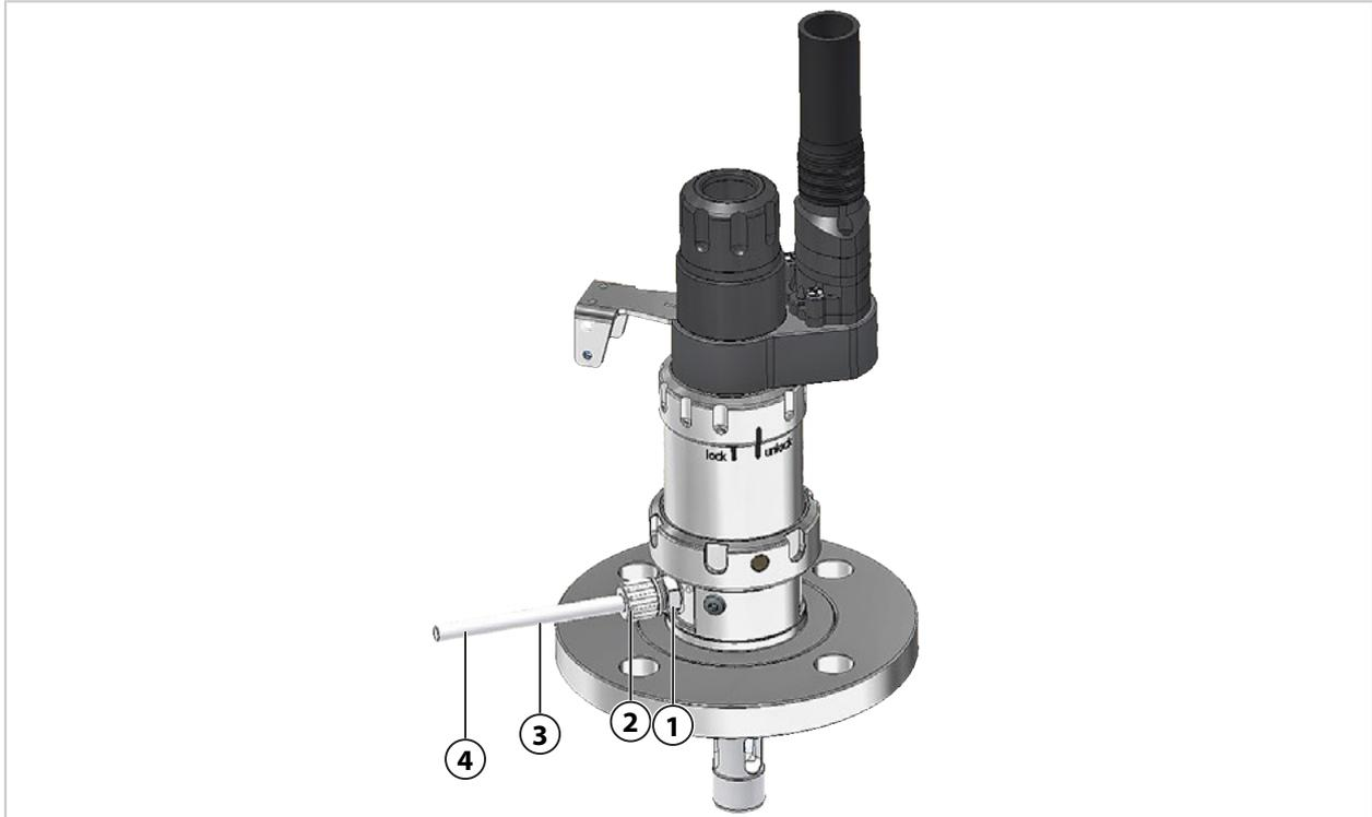
01. Abflussschlauch (3) mittels Schlauchverschraubung (2) an Abflusstutzen (1) fest anschrauben.
