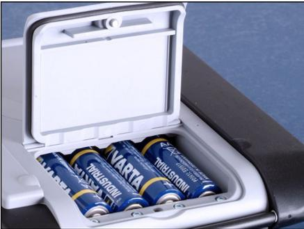
Mit vier Mignon-Batterien erreicht das Portavo mehr als 1000 h Laufzeit. Das Batteriefach auf der Rückseite des Gerätes öffnen. Beim Einlegen der Batterien Polarität beachten (siehe Kennzeichnung im Batteriefach). Batteriefachdeckel schließen und handfest zuschrauben.
