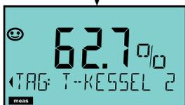
Kurzes Drücken von **meas** ruft weitere Displaydarstellungen auf, zum Beispiel Messstellenbezeichnung (TAG) oder Durchfluss (l/h). Diese sind türkis hinterleuchtet und wechseln nach 60 s zum Hauptdisplay.
