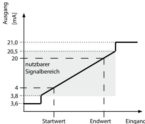
**Verhalten des Ausgangsstroms (0 ... 20 mA) bei Messbereichsüber- bzw. -unterschreitung**
