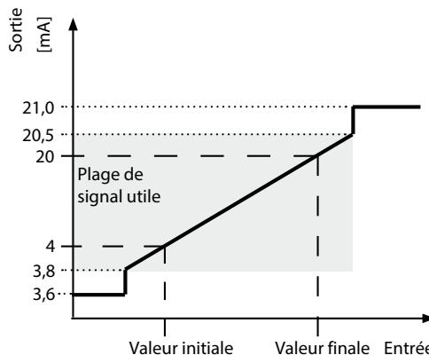
**Comportement du courant de sortie (0 ... 20 mA) en cas de dépassement positif ou négatif de la plage de mesure**
