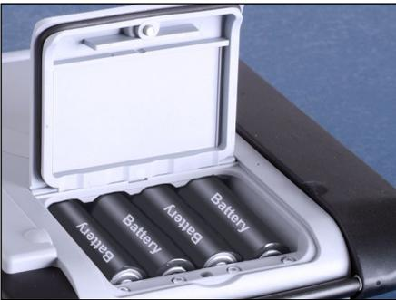
Mit vier Mignon-Batterien erreicht das Portavo im Loggerbetrieb eine Laufzeit von bis zu 500 h (siehe Seite 38). Das Batteriefach auf der Rückseite des Geräts öffnen. Beim Einlegen der Batterien Polarität beachten (siehe Kennzeichnung im Batteriefach). Batteriefachdeckel schließen und handfest zuschrauben.
