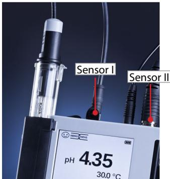
Die Memosens-Sensoren werden an Sensorbuchse I und II oder ein Memosens-Sensor an Sensorbuchse I und der analoge Sensor an Sensorbuchse II angeschlossen.
