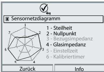
Beispiel: Netzdiagramm eines digitalen pH-Sensors (Memosens)
