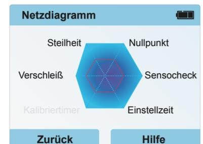
Mit dem übersichtlichen Netzdiagramm ist es dem Wartungspersonal einfach möglich, den aktuellen Zustand des Sensors mit einem Blick zu erfassen.
