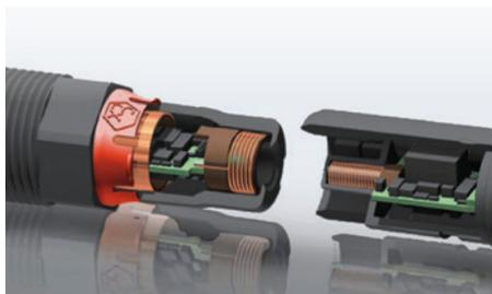
*Der Messwert wird bereits im Sensor digitalisiert und kontaktlos zum Messumformer übertragen. Neben der bi-direktionalen Signalübertragung wird der Sensor über die induktive Kopplung auch mit Energie versorgt.*
