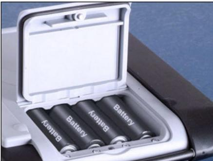
Mit vier Mignon-Batterien erreicht das Portavo mehr als 1000 h Laufzeit. Das Batteriefach auf der Rückseite des Geräts öffnen. Beim Einlegen der Batterien Polarität beachten (siehe Kennzeichnung im Batteriefach). Batteriefachdeckel schließen und handfest zuschrauben.
