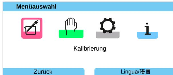
Bei der Kalibrierung bleibt Stratos Multi im Kalibriermodus, bis dieser durch das Fachpersonal beendet wird. Beim Verlassen des Kalibriermodus wird eine Sicherheitsabfrage angezeigt, um sicherzustellen, dass die Anlage wieder betriebsbereit ist.
